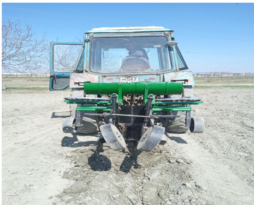
5-rasm. Kombinatsiyalangan qalamcha ekish apparatining traktorga agregatlangan holati.
